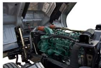
Motor Turbo Diesel, 4 cil. en línea, 4 ciclos, enfriado por agua
